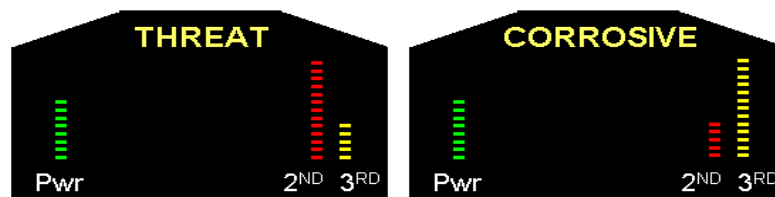
Рис.2. Сравнение уровней сигналов 2-ой и 3-ей гармоник при работе с НЛ (слева - полупроводник, справа - ложное соединение)
