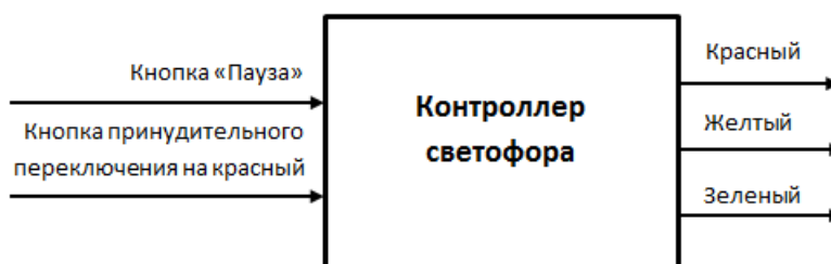
Рисунок 4.7: Входные и выходные сигналы автомата «контроллер светофора»
