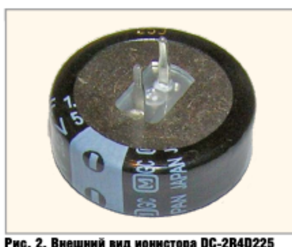
Рис. 2. Внешний вид ионистора DC-2R4D225 ёмкостью 1 F на напряжение 5,5 В (модель 1905V)
