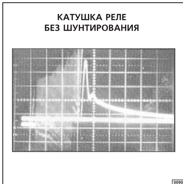
Отключение индуктивной нагрузки вызывает очень сложный переходный процесс Рисунок 33
