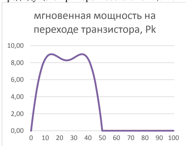
Рисунок 4. а) мощность на переходе транзистора, б) температура перехода кристалла.
