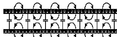
Рис.12. Взаимосвязь между параллельными сигнальными проводниками
