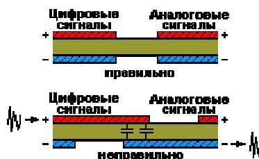
Рис.1. Размещение полигонов аналоговых и цифровых сигналов
