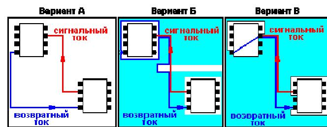
Рис. 8. Образование петли и щелевой антенны при некорректном разводке
