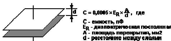
Рис.10. Расчет межслойной емкости
