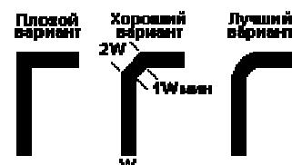
Рис.9. Сглаживание углов проводников
