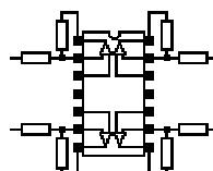
Рис.18. Зеркальная разводка проводников для счетверенного ОУ
