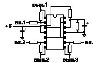
Рис.19. Счетверенный ОУ с формирователем половины напряжения питания
