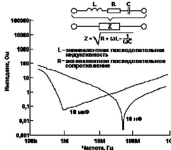
Рис.15. Собственный резонанс конденсатора
