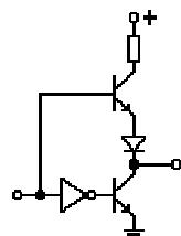
Рис.14. Структура выходного каскада логического элемента
