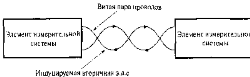
Рис. 6.1. Уменьшение интерференции при помощи витых пар проводов
